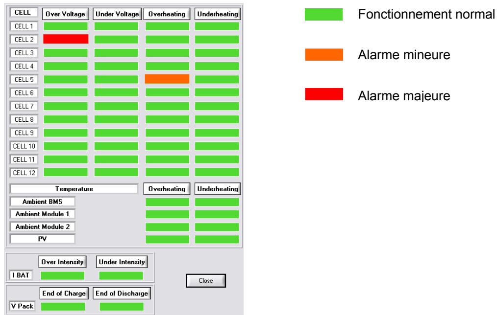
Figure 4.18 : Interface Graphique des Registres d'Alarme du logiciel de supervision temps réel Module LiPV.
