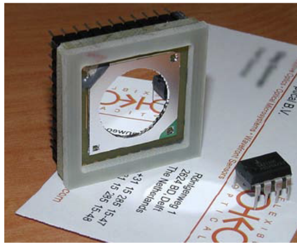
FIG. 5.4 – Le miroir déformable électrostatique OKO à 37 actionneurs
