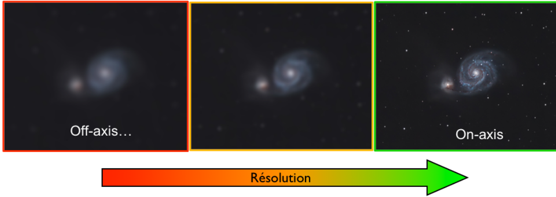
FIG. 2.19 – Effet de l'anisoplanétisme. La correction devient de moins en moins bonne au fur et à mesure que la direction d'intérêt scientifique (ici une galaxie) s'éloigne angulairement de l'axe d'analyse.
