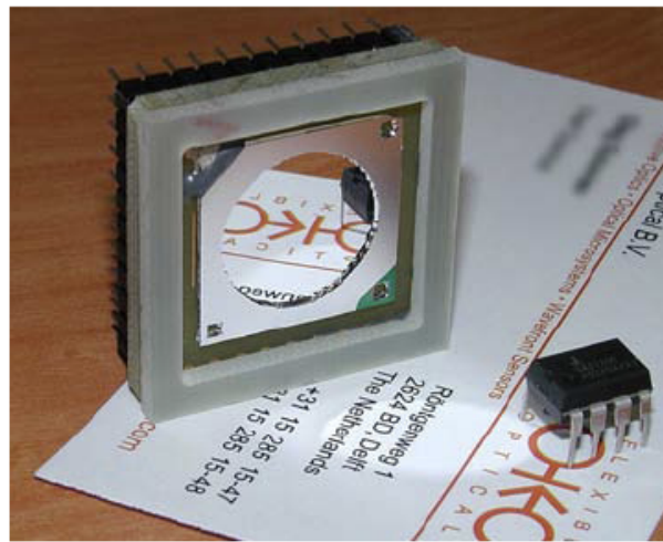
FIG. 5.4 – Le miroir déformable électrostatique OKO à 37 actionneurs
