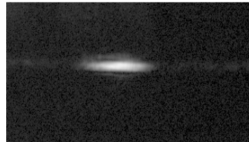
Figure IV.19 : (de gauche à droite) Schéma de principe du guide d'onde ruban, vue du dessus du guide ruban avec une sonde à 633 nm et image du mode de sortie.
