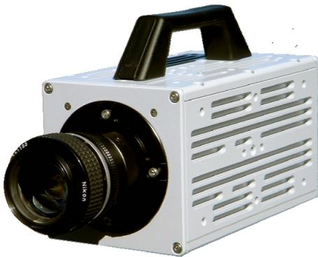
Figure V.7 – Caméra filmant et photographiant les écoulements hydrodynamiques
