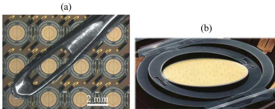
FIG. 1.1 – (a) matrice de micromiroirs utilisée sur un routeur optique comparée à une tête d'aiguille, (b) miroir inclinable sur deux angles [PAS05].
