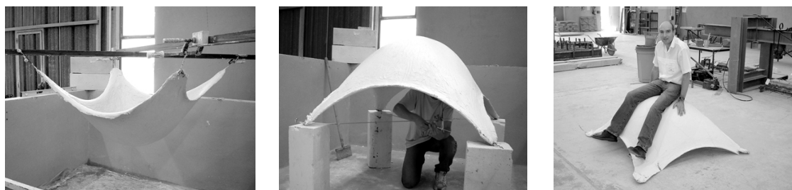
Fig. I.25 : Modèle physique de coque mince en béton
