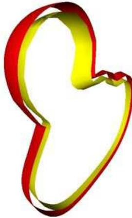
FIG. 2.3: Approximation d'un offset par une grille de 144 carreaux biquadratiques (vue en coupe).
