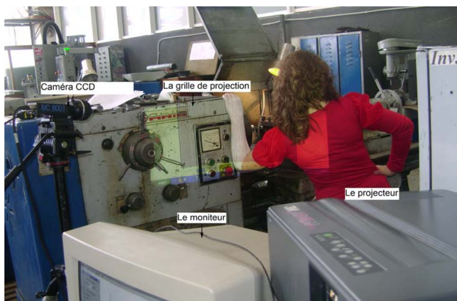
Fig. 5.39. L'emplacement des appareils pour la réalisation des mesures par la méthode Moiré de projection
