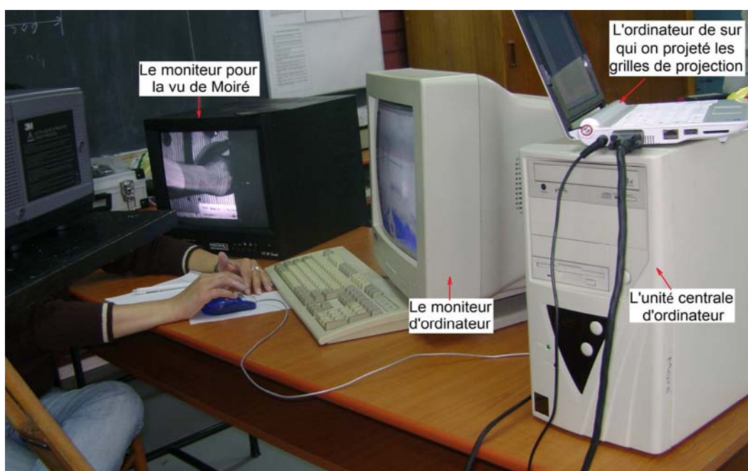
Fig. 5.43. Le system pour l'acquisition et de traitement des données obtenues par la méthode Moiré de projection
