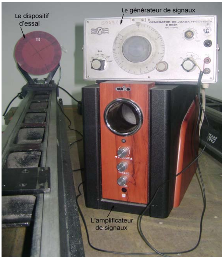
Fig. 5.9. L'emplacement du dispositif, de l'amplificateur et du générateur de signaux [RUN 09b]
