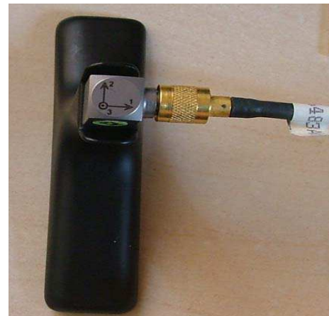
Fig. 6.1. L'accéléromètre tridimensionnel utilisé pour l'acquisition des données des mesures
