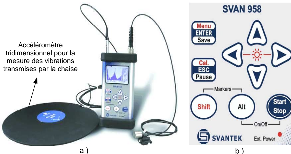
Fig. 5.7. L'appareil SVAN 958 pour la mesure des vibrations et des bruits: a) L'appareil; b) Le menu principal de l'appareil
