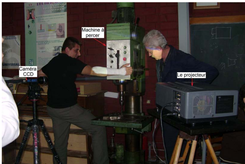
Fig. 5.42. L'emplacement de la caméra CCD et du projecteur pour la réalisation des mesures par la méthode Moiré de projection
