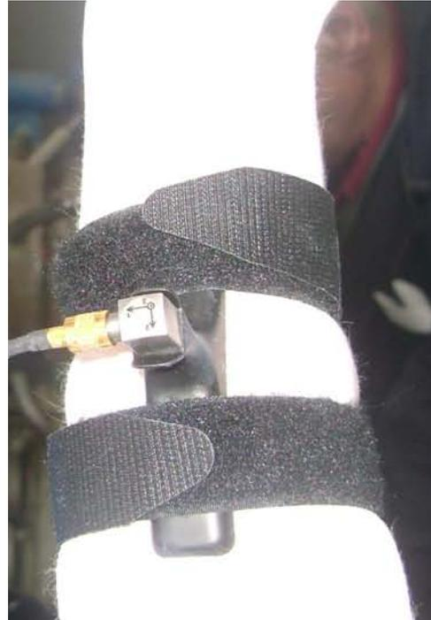
**Fig. 6.3** L'accéléromètre monté sur l'avant-bras
