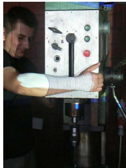
**Fig. 6.50.** La position de la main sur la machine à percer verticale
