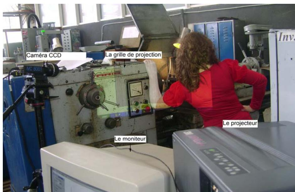
**Fig. 5.39.** L'emplacement des appareils pour la réalisation des mesures par la méthode Moiré de projection
