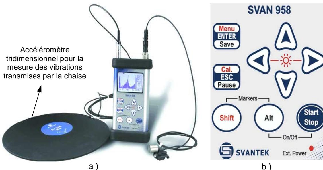
**Fig. 5.7.** L'appareil SVAN 958 pour la mesure des vibrations et des bruits:
