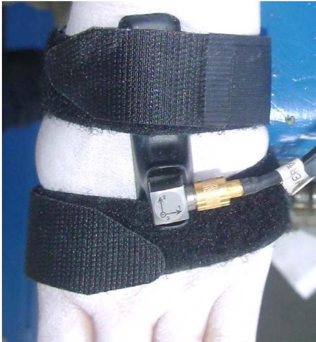
**Fig. 6.2.** L'accéléromètre monté sur la main
