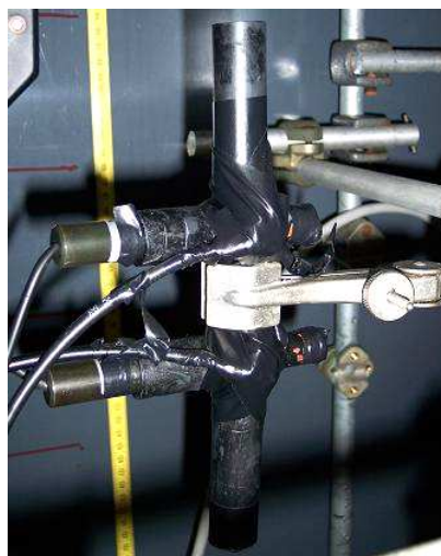
Figure II. 8 : Dispositif de mesure de la vitesse instantanée de la goutte.
