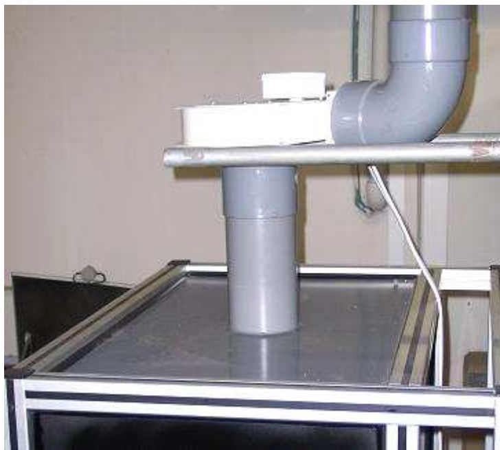
Figure II. 11 : Dispositif d'extraction d'air.
