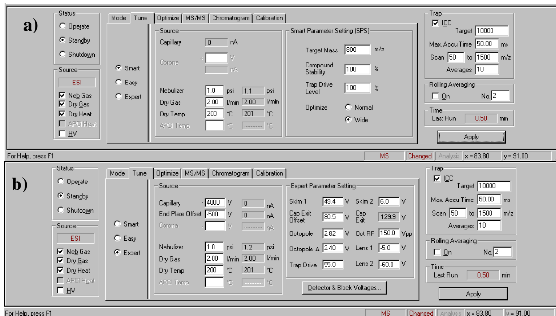
Figure 6a et 6b : Fenêtres de contrôles des paramètres du spectromètre de masse Esquire~LC Bruker Daltonics). a) mode simple permettant l'optimisation automatique en fonction de la valeur m/z de l'ion ("target mass"), de l'énergie de transmission ("Compound stability") et de la profondeur du puits de piégeage ("trap drive") b) mode permettant l'ajustement manuel de chacun des paramètres de transmission de l'ion.
