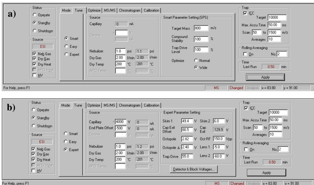
Figure II.5 : Fenêtres de contrôles des paramètres du spectromètre de masse Esquire~LC (Bruker Daltonics). a) mode simple permettant l'optimisation automatique en fonction de la valeur  $m/z$  de l'ion ("target mass"), de l'énergie de transmission ("Compound stability") et de la profondeur du puits de piégeage ("trap drive") b) mode permettant l'ajustement manuel de chacun des paramètres de transmission de l'ion.
