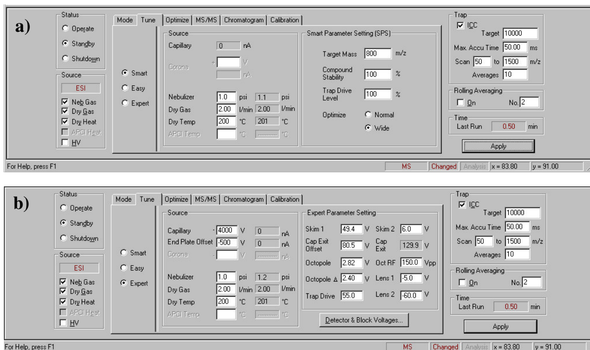
Figure II.5 : Fenêtres de contrôles des paramètres du spectromètre de masse Esquire~LC (Bruker Daltonics). a) mode simple permettant l'optimisation automatique en fonction de la valeur m/z de l'ion ("target mass"), de l'énergie de transmission ("Compound stability") et de la profondeur du puits de piégeage ("trap drive") b) mode permettant l'ajustement manuel de chacun des paramètres de transmission de l'ion.
