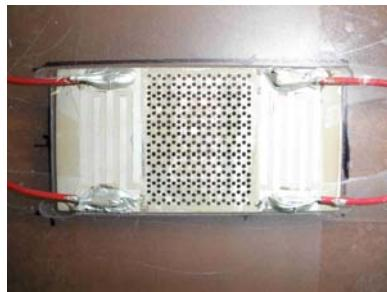
Figure 2 Cristal phononique réalisé dans une céramique piézoélectrique. Electrodes interdigitées pour la réception et l'émission des ondes guidées.
