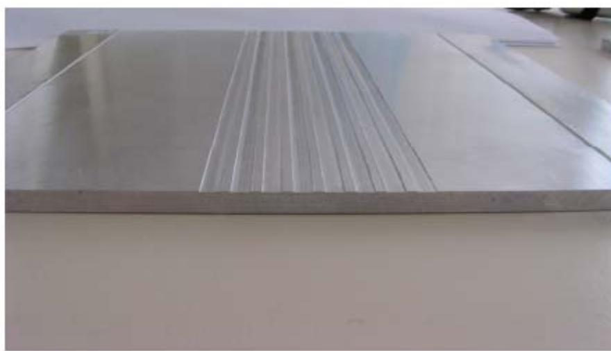
Figure 10 : Photographie de l'échantillon à stries rectangulaires.
