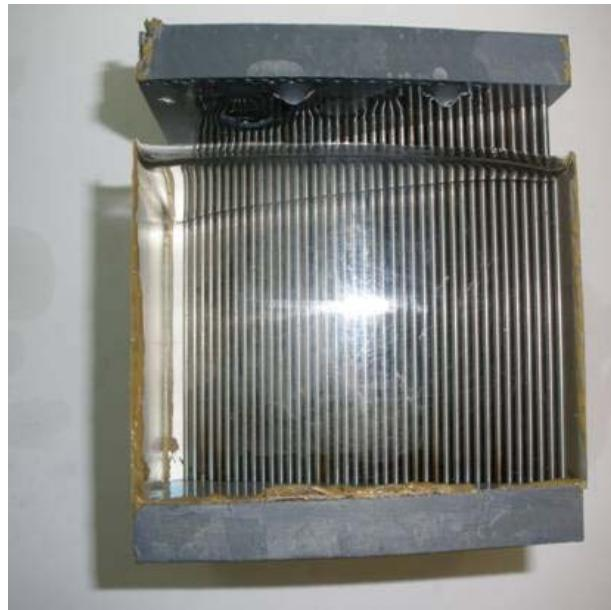
Figure 12 Résine époxy coulée dans le réseau de tiges d'acier maintenu par deux plaques parallèles de PVC.
