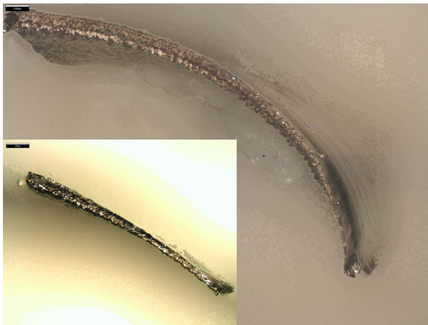
FIG. 3.31 – Forme caractéristique d'un copeau en fraisage. Observation de la tranche pour des mesures d'épaisseur (échelle indiquée 100\mu\text{m} ).
