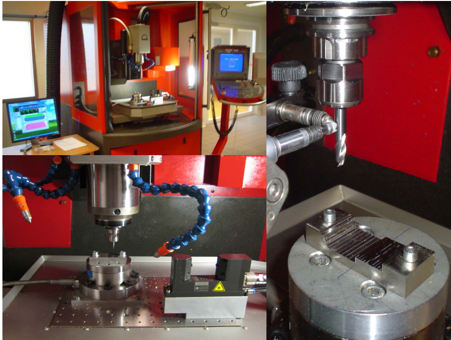
FIG. 3.4 – Photos illustrant la mise en place du système d'acquisition sur la machine KERN.
