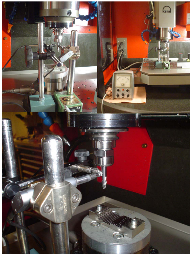
FIG. 3.25 – Montage permettant la mesure du faux-rond radial par contact sur l'outil.
