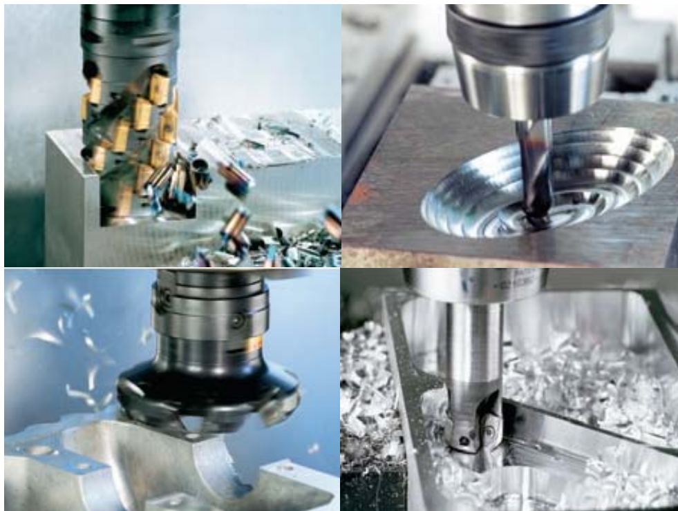
FIG. 1.5 – Images de différentes opérations de fraisage industrielles. ( Sandvik, 2008 )[3]
