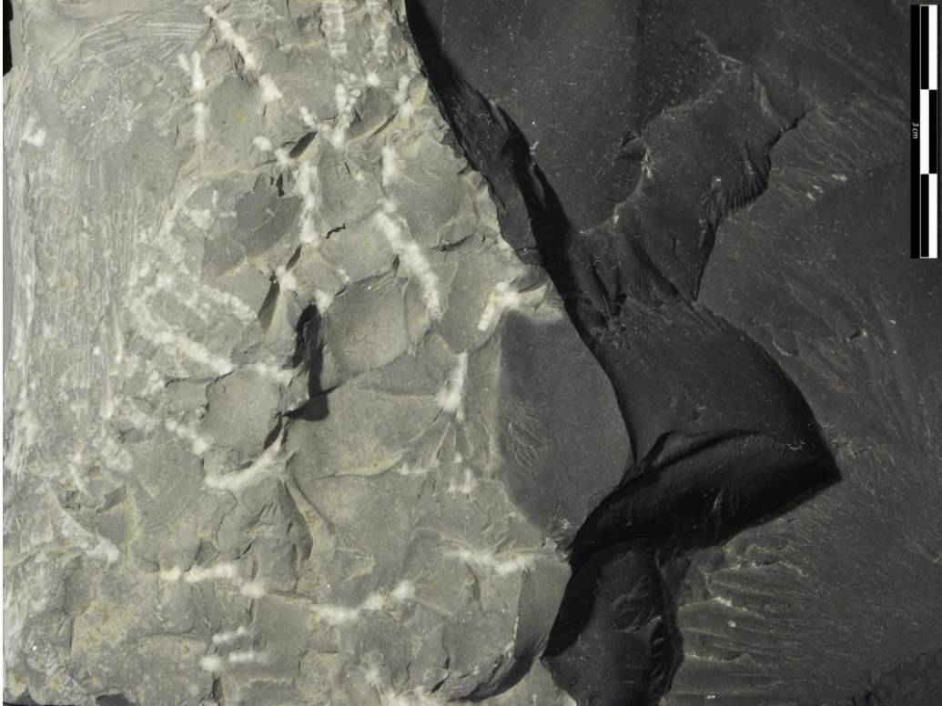
Figure 68 : calcaire carbonifère d'excellente qualité patiné (gris, à gauche) et non patiné (noir, à droite). Le matériau est tendre mais permet le développement d'une cassure conchoïdale et se débite parfois aussi bien que le silex (cliché K. Di Modica, © Archéologie Andennaise)
