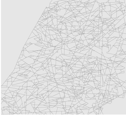
image 6 : réseau de base Suppression de tous les segments possédants 1 ou 2 extrémités libres par « Ebarbulages » réitérés de l'image « 5 » jusqu'à l'idempotence
