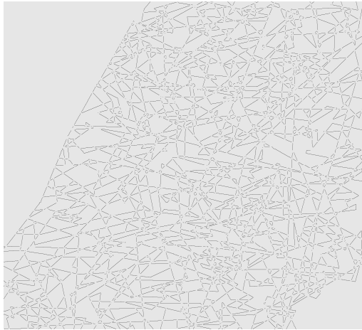
image 12 Fonction «Ebarbulage» (réitérée 10 fois) appliquée sur l'image «11» ; cette opération enlève 10 pixels à toutes les extrémités des segments.
