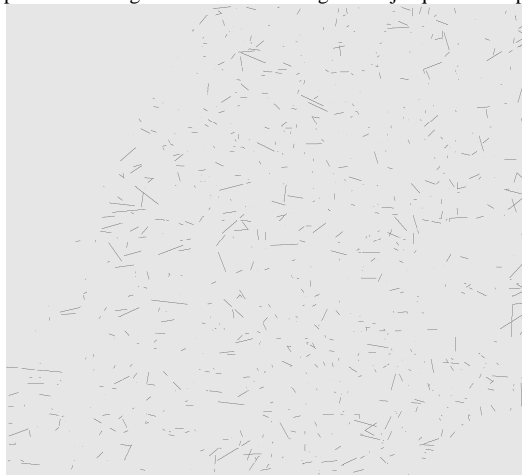
image 9 : impasses Linéaments «impasses» obtenus avec la fonction «Différence Logique» appliquée aux images « 7 » et « 6 ».
