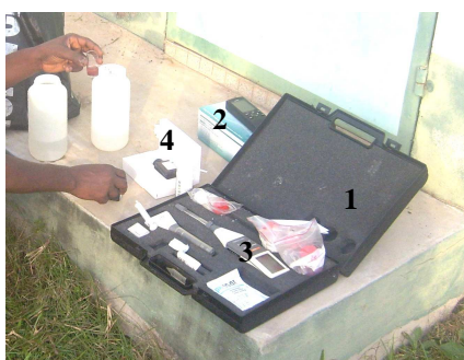
1 : Mallette de terrain comprenant le pH-mètre et ses accessoires 2 : GPS ; 3 : PH-mètre 4 : Coffret de mesure du THT
