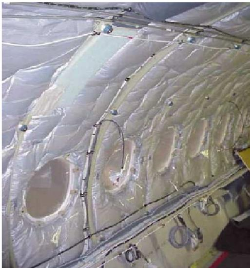
FIGURE 1.1 - Laine de verre dans la paroi d'un avion.
