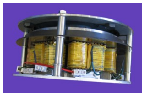
FIGURE 1.10: Machine à stator en U pour véhicule hybride (référence [Van Tichelen et al. , 2003])
