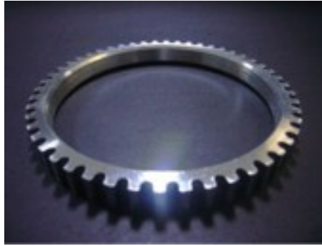
FIGURE 5.33: Capteur denté de position pour un système ABS (référence [Bas et al. , 2003])
