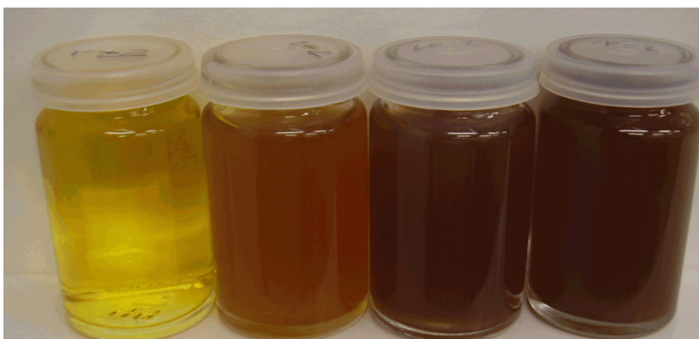
Après conversion Après 1 jour Après 6 jours Après 8 jours Figure 116 : Evolution dans le temps à 4°C de la phase aqueuse de conversion hydrothermale du glucose (batch, 300°C, 25 MPa, 30 minutes)
