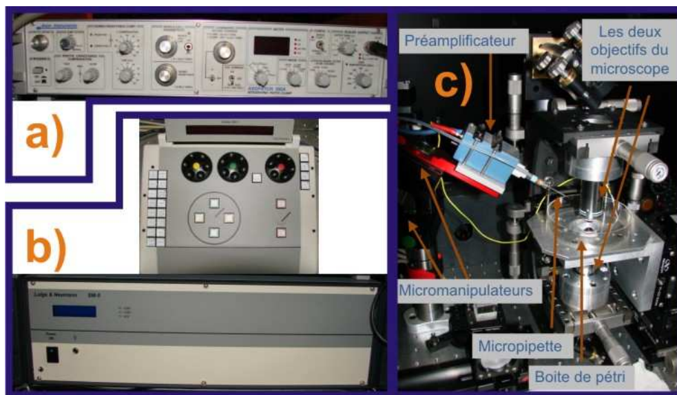
Figure VI-7 : vue d'ensemble de l'installation de la mesure de patch-clamp sur le microscope. a) le système Axopatch, b) le système de contrôle des micromanipulateurs, c) configuration des micromanipulateurs et le préamplificateur sur le PLEOM.
