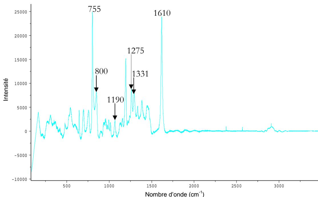
**Figure IV.42 :** Spectre Raman de la RTM6 à température ambiante
