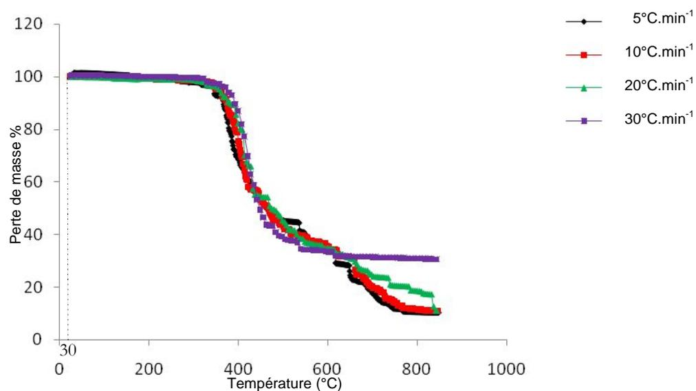
Figure IV.24 : ATG pour la RTM6 à 1%  $\text{TiO}_2$  à 5, 10, 20 et  $30^\circ\text{C}.\text{min}^{-1}$
