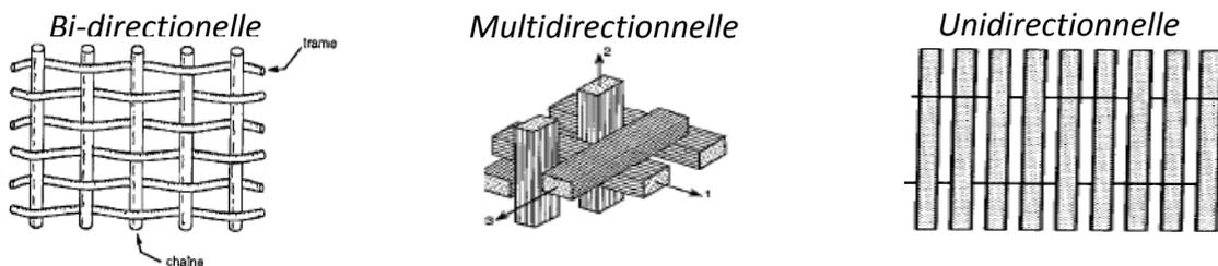
Figure I. 2 : Principales orientations des fibres
