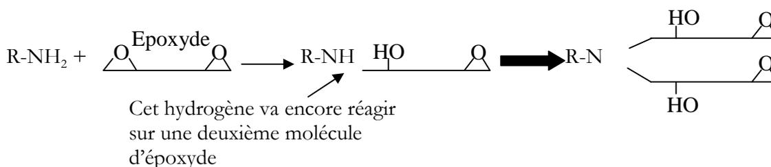
**Figure II.4 :** Mécanisme réactionnel pendant le processus de polymérisation
