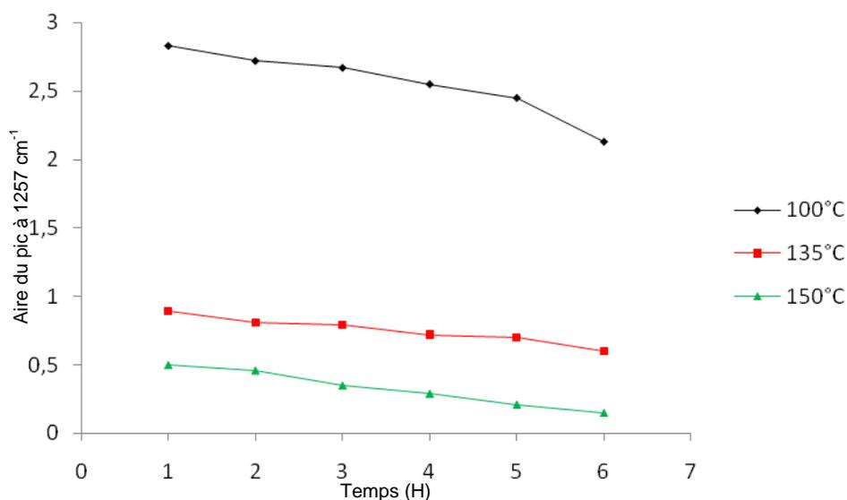
**Figure IV.40 :** Variation de la quantité d'époxy en fonction du temps pour 100, 135 et 150°C
