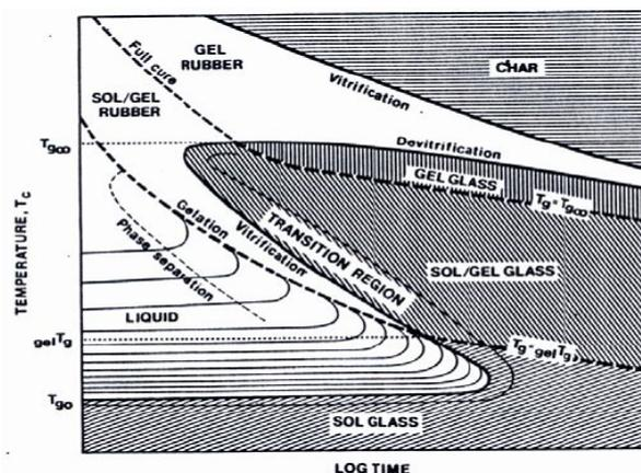
Figure II.5 : Diagramme : Temps-Température-Transformation (TTT)
