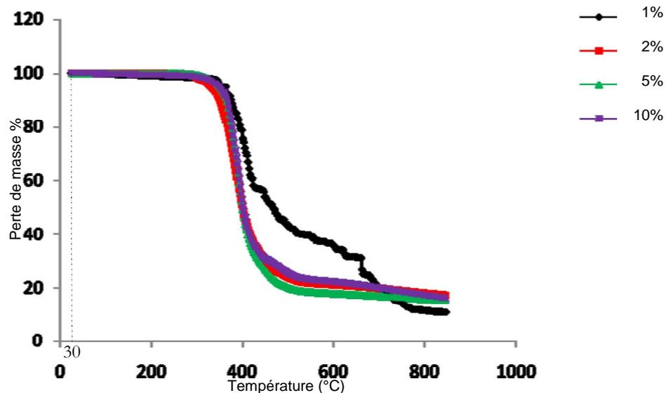
Figure IV.23 : ATG pour la résine RTM6 à  $10^\circ\text{C}.\text{min}^{-1}$  à différents taux de  $\text{TiO}_2$
