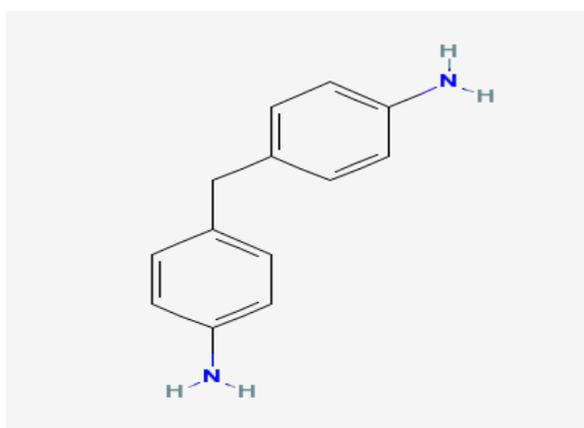
**Figure II.7** : Structure développée du durcisseur Polyamine
