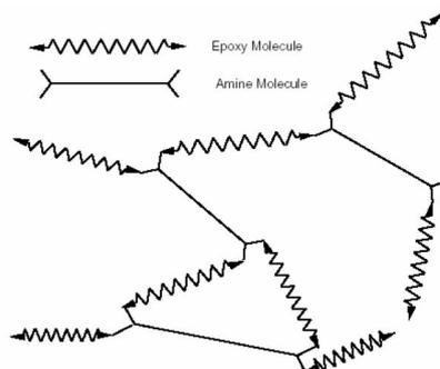
Figure II.8 : Représentation schématique de la résine époxyde
