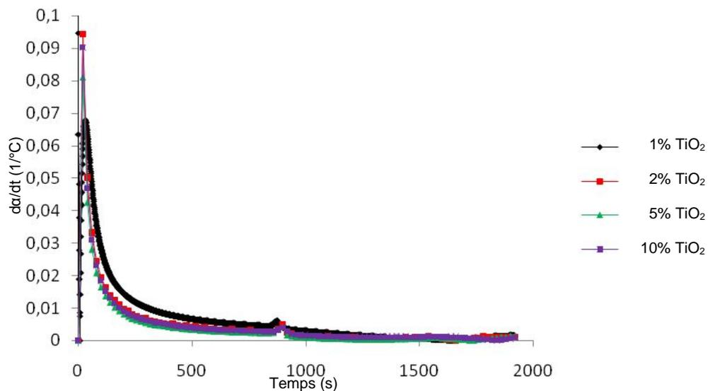
Figure IV.20 : Vitesse de réaction de la RTM6 à différents taux de TiO<sub>2</sub>
