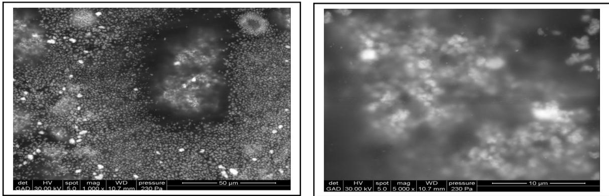
**Figure IV.16 b :** MEB de l'échantillon RTM6 à la surface de l'échantillon à 1% de  $\text{TiO}_2$
