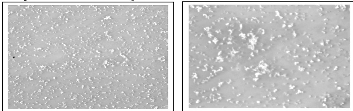
Figure IV.15 a : MEB de la RTM6 au cœur de l'échantillon à 1% de TiO<sub>2</sub>
