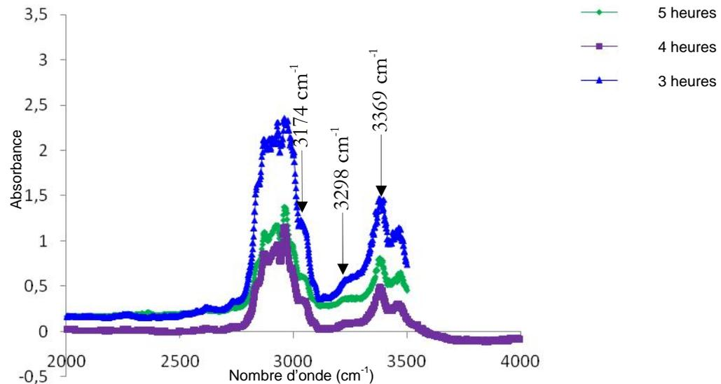
**Figure IV.39 :** Spectres Infra-Rouge de la RTM6 de 01 Heure à 06 Heures à 150°C
