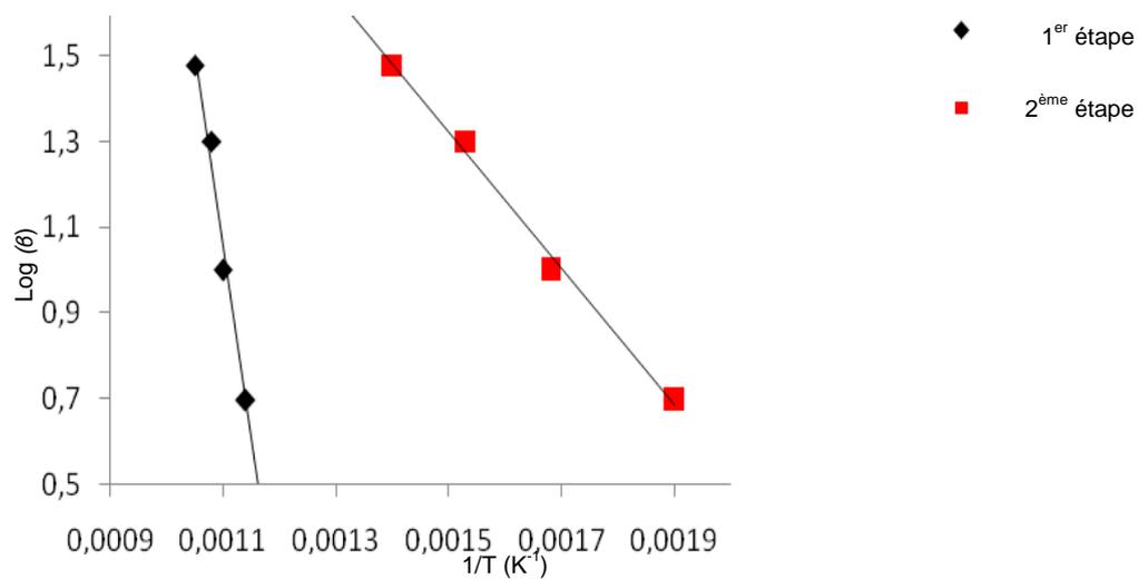
**Figure IV.31 :** Variation de  $\log \beta$  en fonction de  $1/T$  de la RTM6 avec TiO<sub>2</sub> pour le calcul de l'énergie d'activation par Flynn-Wall-Ozawa
