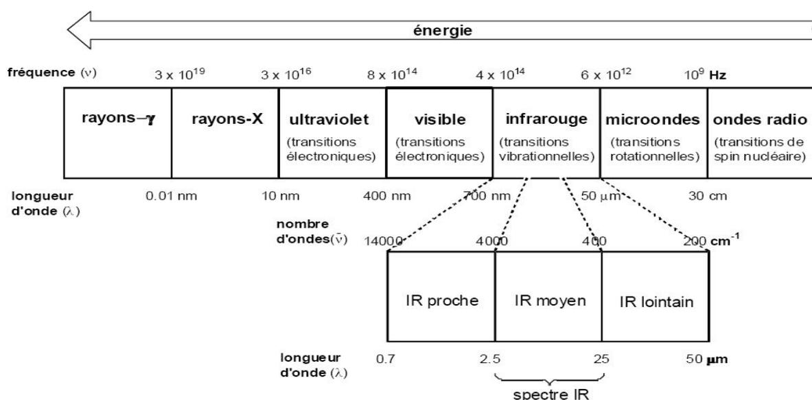
Figure III.1 : Spectre électromagnétique
