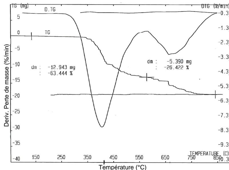
**Figure IV.22 :** Courbes de DTG de l'échantillon à  $10^{\circ}\text{C}\cdot\text{min}^{-1}$
