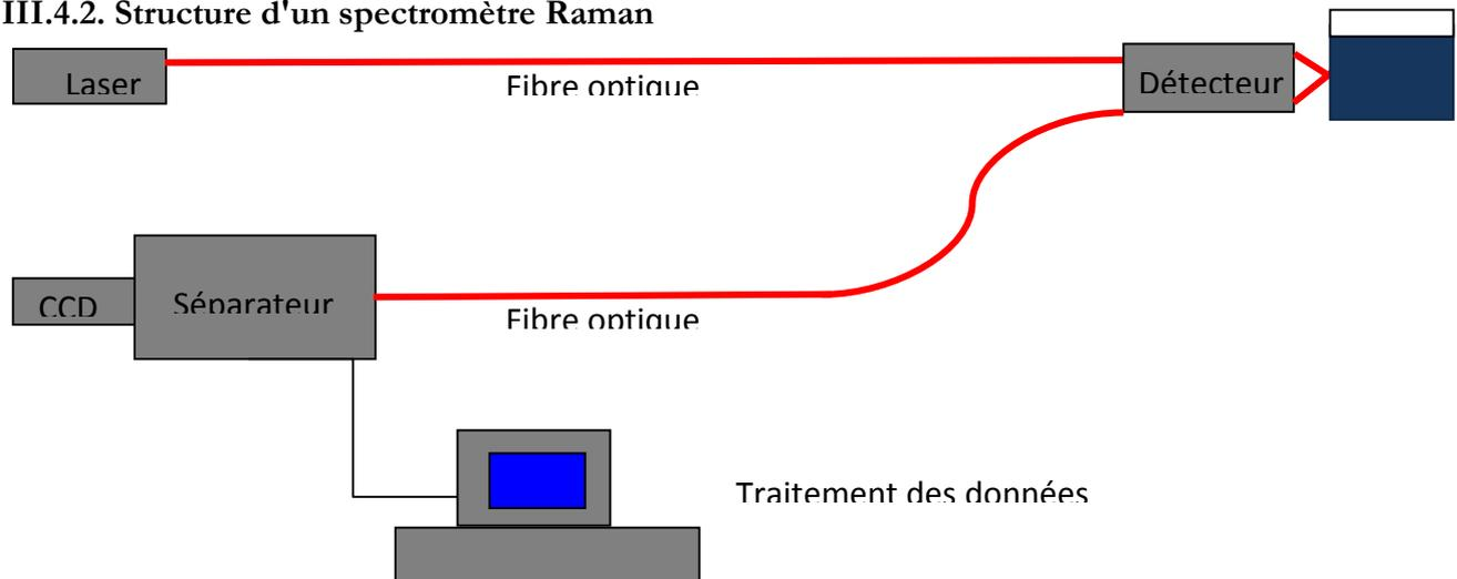
Figure III.4 : Schéma de principe d'un spectromètre Raman
