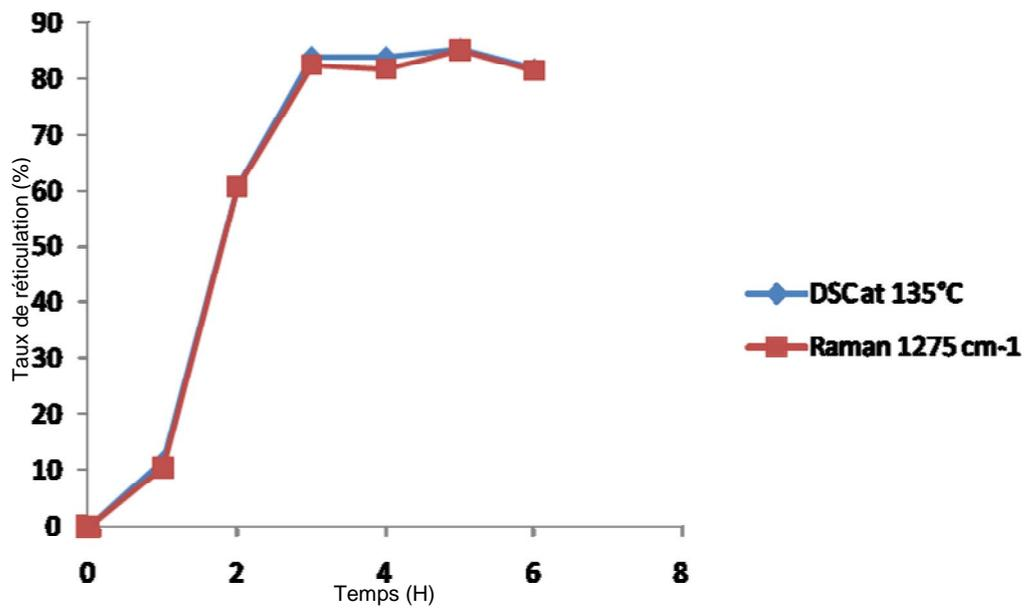
Figure IV.46 : Taux de réticulation par la DSC et le Raman à 135°C
