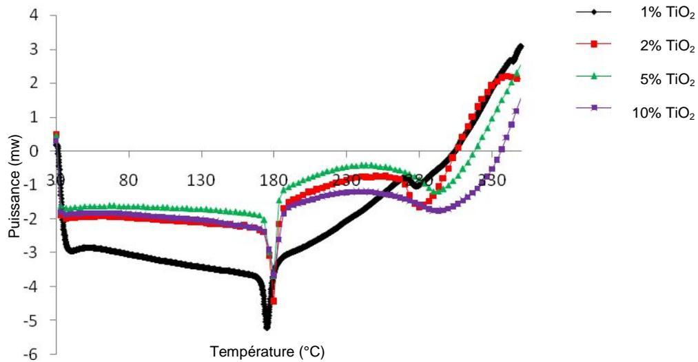
Figure IV.19 : DSC de la RTM6 à 135°C à 10°C.min<sup>-1</sup> à différents taux de TiO<sub>2</sub>
