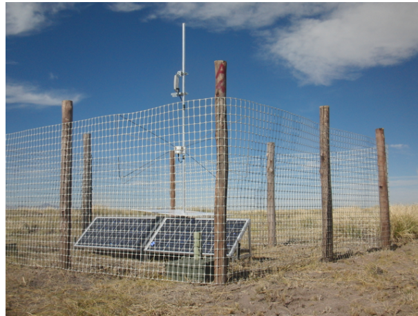
FIGURE 4.38 – Photo d'une station autonome installée à RAuger. Le grillage en plastique permet de maintenir éloignés les animaux un peu trop curieux de ce mystérieux objet de la pampa.
