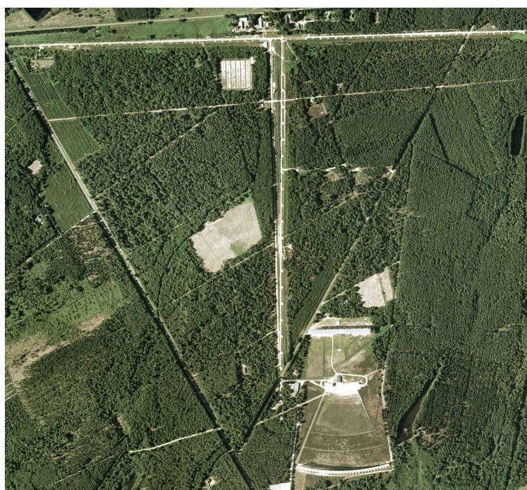
FIGURE 2.2 – Vue aérienne de l’observatoire. Le radiohéliographe est distribué autour du T largement visible, d’1.5 km de côté. Les miroirs du radiotélescope apparaissent au Sud. Le réseau décimétrique est le petit carré clair en haut de l’image. Les bâtiments techniques et administratifs sont visibles au Nord.
