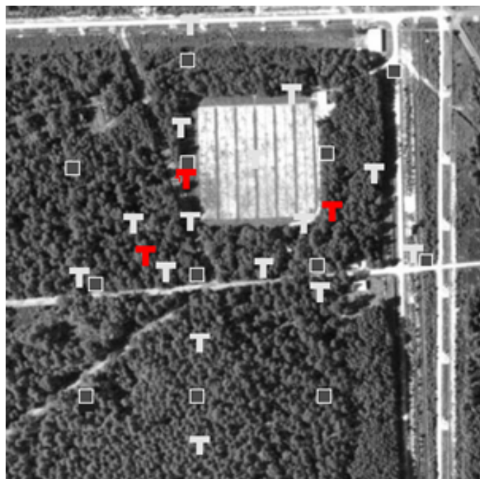
FIGURE 3.11 – Localisation des 3 antennes sensibles à la polarisation Nord-Sud (en rouge), au centre du réseau.
