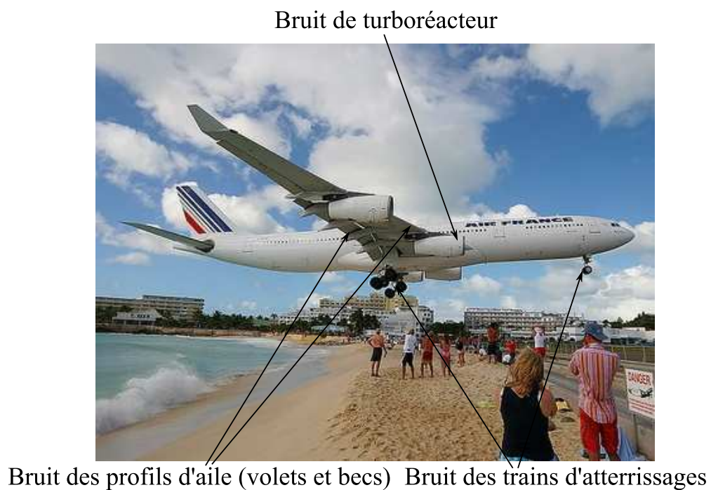
FIG. 1 – Sources de bruit d'un avion.
