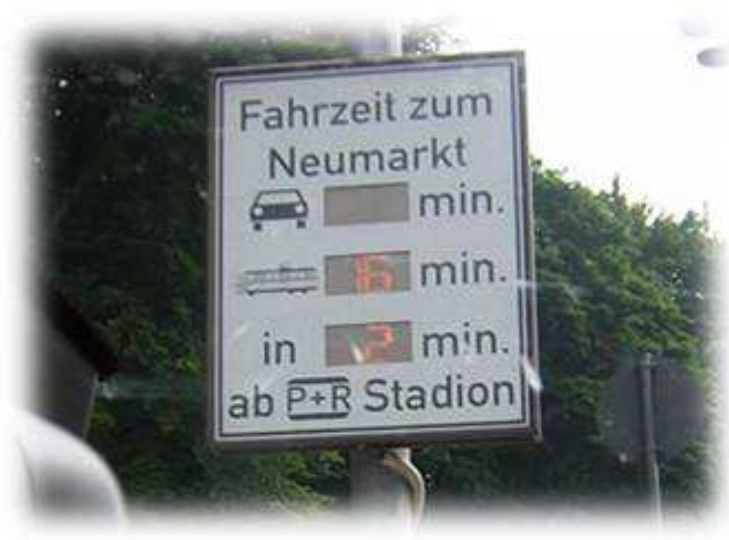
FIGURE 5.10 – Exemple de PMV diffusant une information multimodale de temps de parcours
