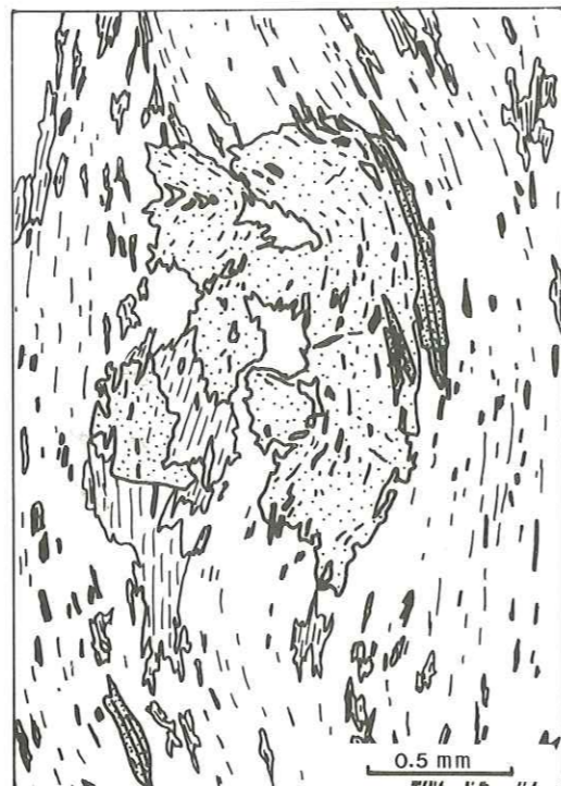
Ech. 572 - Zone III - Chlorite, grenat, chloritoïde (pointillé serré); fond de la roche : opaques, musc., quartz, plagioclase.
