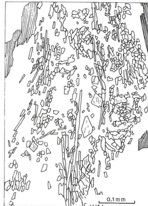
Ech. A111 - Zone VI - Sillimanite prismatique sur du quartz; au centre, sections transversales losangiques à clivage (010).
