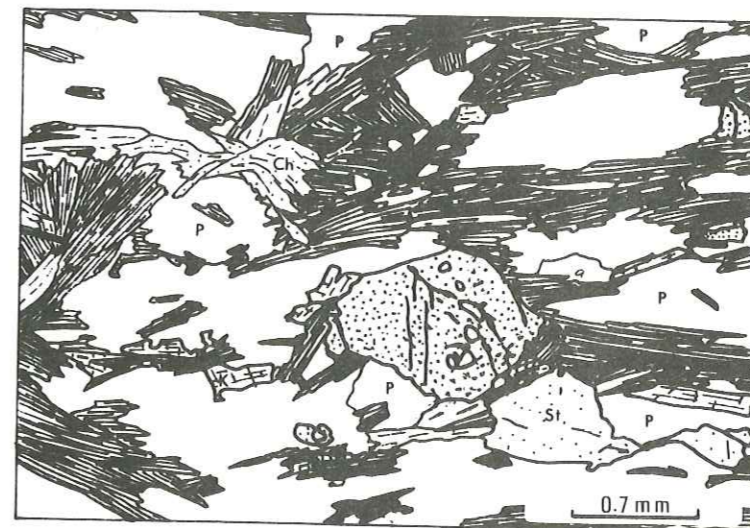
Figure 15. Micrographie de l'échantillon 74.258. Ch = chlorite ; K = disthène ; P = plagioclase ; St = staurotide.
