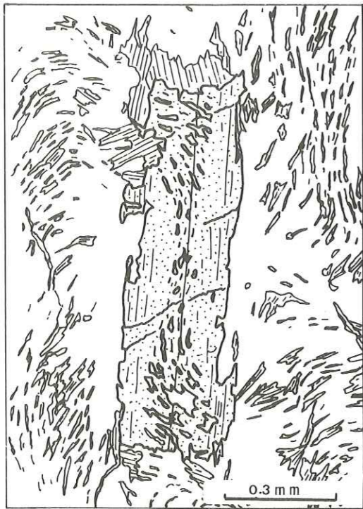
Ech. A 59 - Zone I - Chlorite, chloritoïde (à schistosité interne tournée); fond de la roche : quartz et muscovite.
