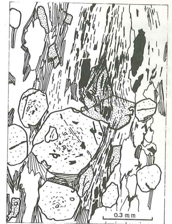
Ech. 692 - Zone IV - Biotite, grenat, staurotide (pointillé serré, schistosité interne marquée par les opaques dans le cristal central maclé); fond de la roche : quartz et muscovite.
