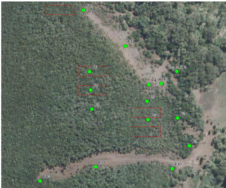
Figure 3.1 : Répartition des piézomètres dans la mangrove sensu stricto (P1 à P9), le drain (P10 à P12) et le tanne (P13 à P15) du site d'étude de Malamani. Les piézomètres P5 et P7 sont équipés de sondes autonomes (Diver)
