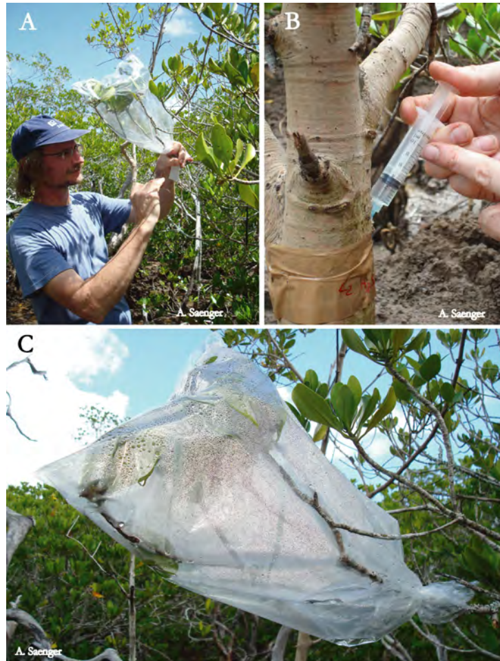
Figure 5.2. Etude de la consommation en eau des palétuviers par traçage isotopique au D_2O : récolte de l'eau évapotranspirée à l'aide de sacs plastiques installés sur des bouquets de feuilles (A et C) et injection du traceur dans les troncs à l'aide d'une seringue (B).
