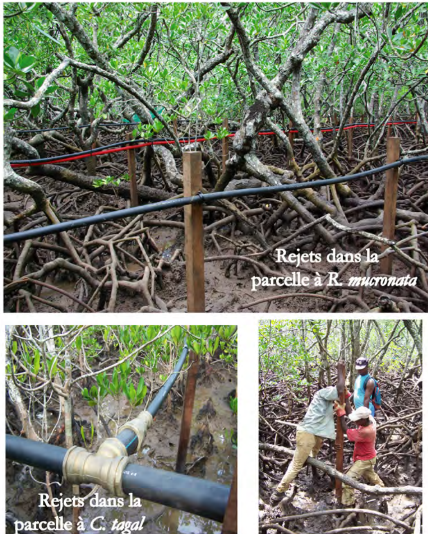
Figure 2.12 : Système de rejets des eaux usées domestiques dans les parcelles expérimentales.
