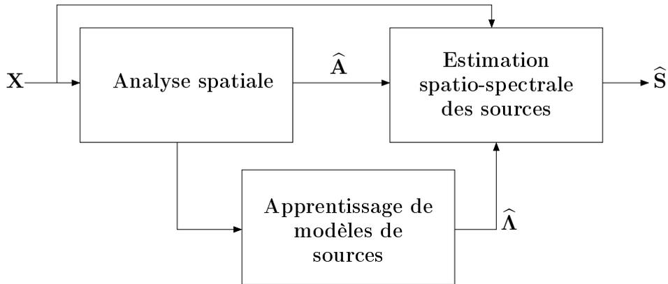
FIG. 14 – Architecture de la méthode de séparation spatio-spectrale que nous proposons.  $\mathbf{X}$  est le mélange mulicanal,  $\hat{\mathbf{A}}$  est l'estimation de la matrice de mélange,  $\hat{\mathbf{\Lambda}}$  est l'estimation des modèles de sources,  $\hat{\mathbf{S}}$  est l'estimation des sources.
