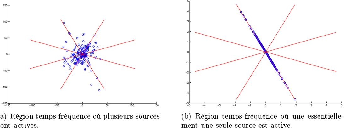
FIG. 2.4 – Diagrammes de dispersion locaux de deux régions temps-fréquence. Les droites indiquent les vraies positions des sources du mélange. La fenêtre de la TFCT est de taille  $L = 4096$ , et la taille du voisinage est de  $|\Omega| = 100$ .
