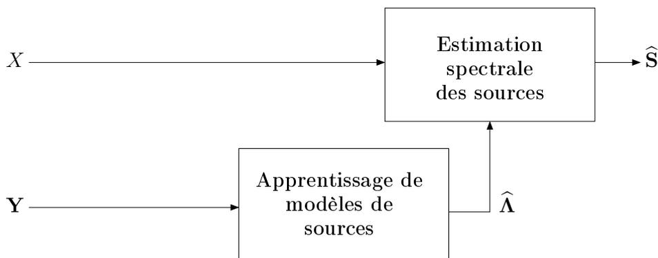
FIG. 13 – Architecture des méthodes de séparation de sources monocanal basées sur des modèles de sources.  $X$  est le mélange monocanal,  $Y$  est un ensemble de sources d'apprentissage représentatif des sources contenues dans le mélange,  $\hat{\Lambda}$  est l'estimation des modèles de sources,  $\hat{S}$  est l'estimation des sources.
