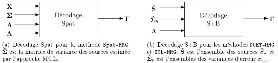
FIG. 8.4 – Schéma bloc des méthodes de décodage aveugle de MMG à complexité linéaire que nous proposons. La sortie  $\mathbf{\Gamma}$  du module de décodage est l'ensemble des estimations des probabilités des états des modèles MMG spectraux des différentes sources.
