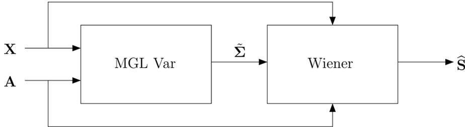
FIG. 8.1 – Schéma bloc de l'approche MGL, où à partir du mélange  $\mathbf{X}$  et de la matrice de mélange  $\mathbf{A}$ , les variances des sources sont estimées en chaque point temps fréquence (on représente par le symbole  $\tilde{\boldsymbol{\Sigma}}$  la valeur de ces estimées), puis les sources sont estimées par filtrage de Wiener.
