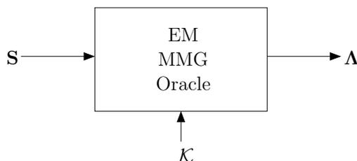
FIG. 8.6 – Schéma bloc de l'apprentissage oracle à partir des sources de référence. L'apprentissage est effectué par l'algorithme EM donné en annexe à la section B.1.  $\mathcal{K}$  désigne le nombre d'états des modèles MMG.
