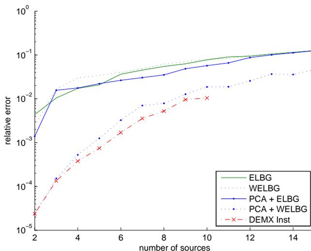
FIG. 7.2 – Erreur d’estimation des directions (en terme de RMDE) en fonction du nombre de sources pour les algorithmes DEMIX-Instantané (DEMIX-Inst) et les meilleurs instances (parmi les  $I = 10$  initialisations) des quatre variantes de la méthode ELBG
