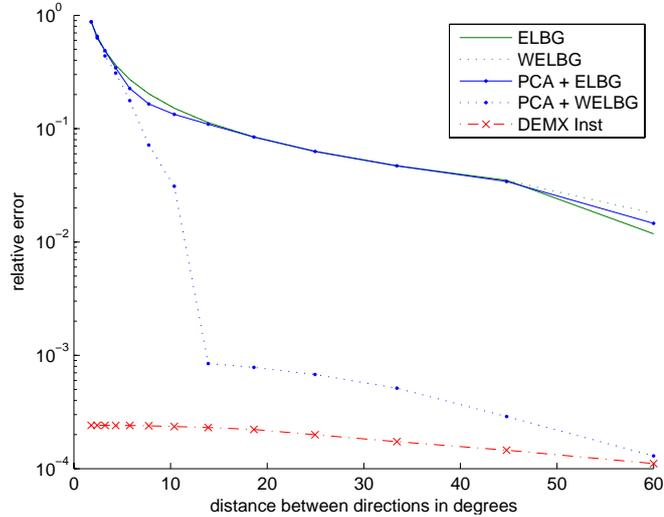
FIG. 7.3 – Erreur d’estimation des directions (en terme de RMDE) en fonction de la distance angulaire entre 3 sources, pour DEMIX-Instantané (DEMIX-Inst) et les meilleurs instances (parmi les  $I = 10$  initialisations) des quatre variantes de la méthode ELBG
