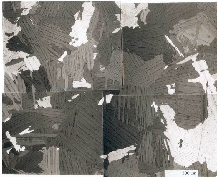
Fig. 9. Microstructure de zirconium 702, traité \beta après polissage électrolytique. Observation par microscopie optique en lumière polarisée [Crepin, 95]
