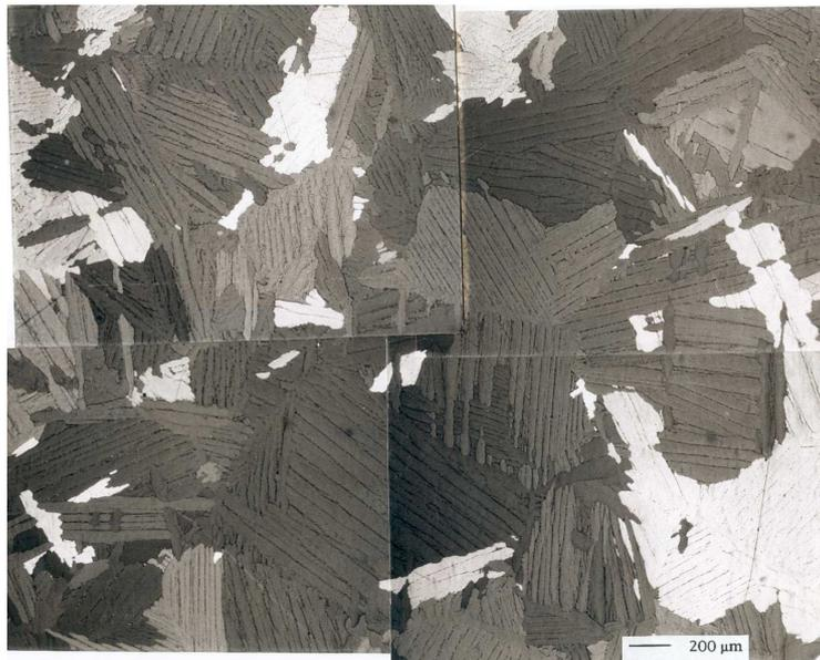
Fig. 9. Microstructure de zirconium 702, traité  $\beta$  après polissage électrolytique. Observation par microscopie optique en lumière polarisée [Crépin, 95]
