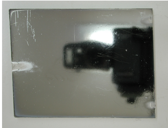
Fig. 2.17. Sustrato de ABS con tratamiento sulfo-crómico + DCP + Cu/Ni/Cr electrolítico.
