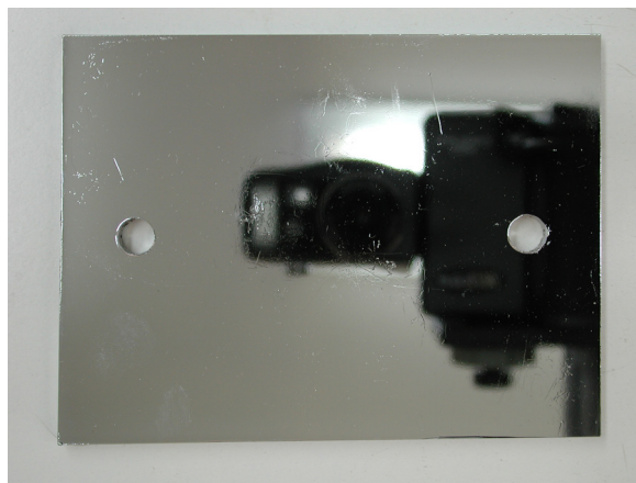
Fig. 2.16. Sustrato de ABS con tratamiento sulfo-crómico + Ni Electroless + Cu/Ni/Cr electrolítico.
