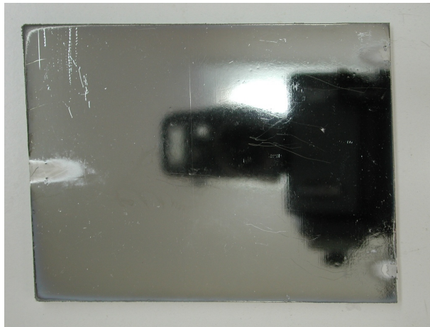
Fig. 2.17. Sustrato de ABS con tratamiento sulfocrómico + DCP + Cu/Ni/Cr electrolítico. (Capítulo 2.3.3).
