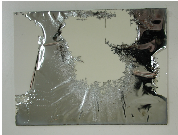
Fig. 3.59. Sustratos de ABS con tratamiento Optofísico (4-60)/1 vez + NiB 200 Jets técnica DCP + Cu/Ni/Cr electrolítico.
