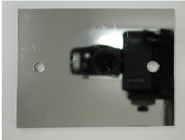
Fig. 2.16. Sustrato de ABS con tratamiento sulfocrómico + Ni Electroless + Cu/Ni/Cr electrolítico. (Capítulo 2.3.3).
