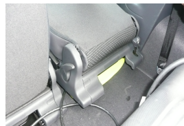
FIGURE 4.17 – Photo du branchement du câble coaxial au niveau du levier de frein à main
