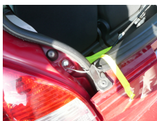
FIGURE C.3 – Photo du branchement du câble coaxial au niveau du coffre arrière gauche
