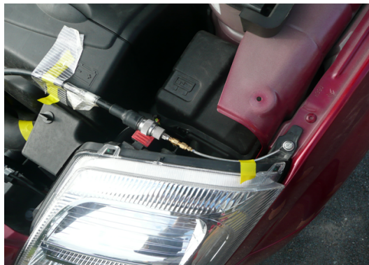
FIGURE C.1 – Photo du branchement du câble coaxial au niveau du phare avant gauche
