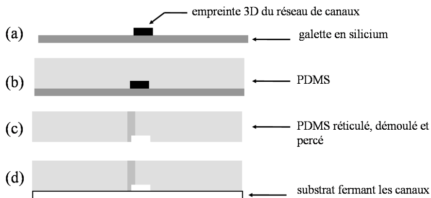
FIGURE 2.2 – Conception de base d’une puce microfluidique en PDMS. (a) : utilisation d’un moule contenant l’empreinte 3D des futurs canaux. (b) : moulage du PDMS. (c) : démoulage et perçage du PDMS. (d) : collage sur un substrat en verre, PDMS ou silicium pour fermer les canaux.
