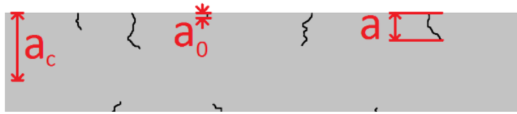
FIGURE 5.13 – Vue latérale de la barrière où tous les défauts sont rapportés dans le même plan. Les défauts de l’interface du haut sont plus grands que ceux de l’interface du bas.
