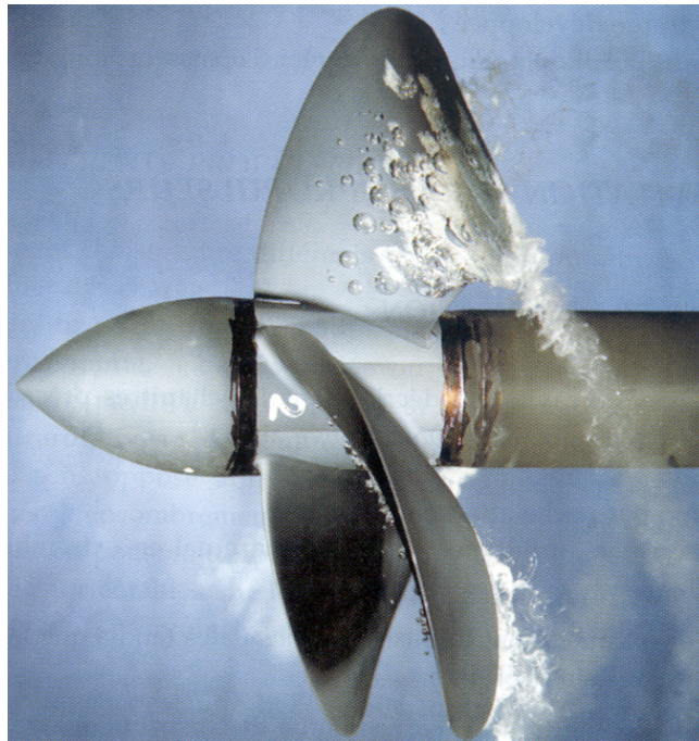
Figure 1.3. Cavitation à bulles suivie d'un nuage de cavitation ; photo BEC (Bassin d'Essais des Carènes)
