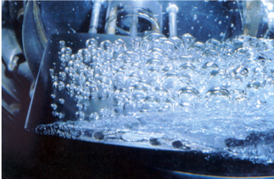
Figure 3.6. Saturation en cavitation par bulles; photo extraite de Franc et al. (1995)
