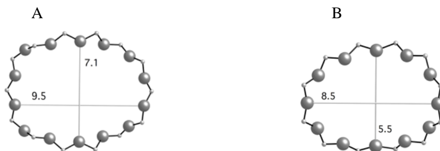
Figure 46 : Ouverture des pores de la zéolithe de type UTL (A) selon l'axe [001], (B) selon l'axe [010]. Dans cette représentation, les plus grosses sphères représentent les atomes d'oxygène et les plus petites les éléments T (T=Si, Ge).
