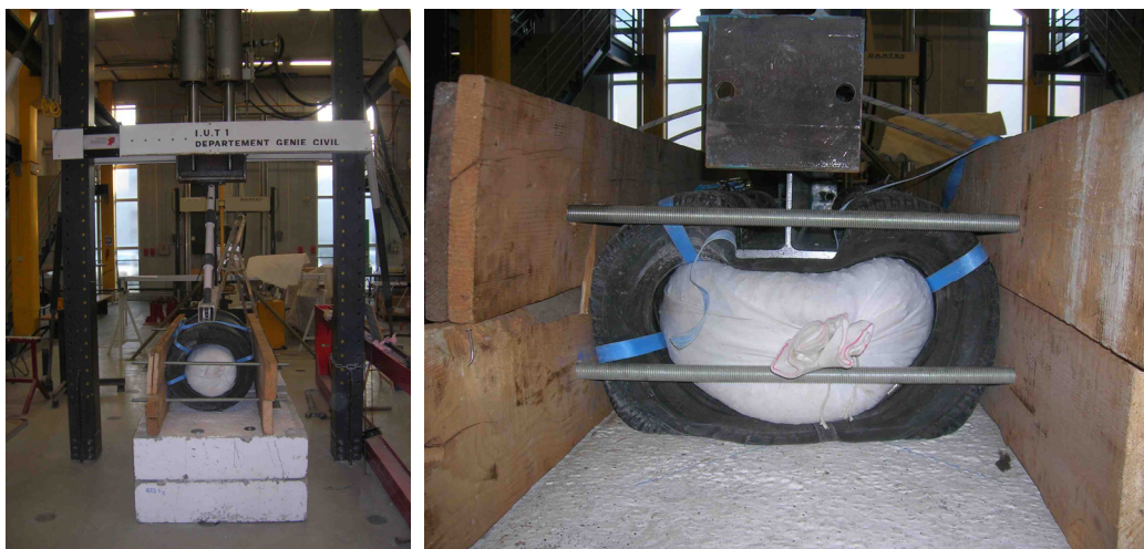
Figure II.11 : dispositif d'essai de compression simple sur colonne de pneus
