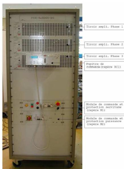
FIGURE 5.4 – Amplificateur de puissance du banc de test universel du G2ELab
