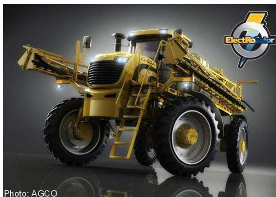
FIGURE 1.11 – Pulvérisateur diesel-électrique E-Gator de AGCO [1]
