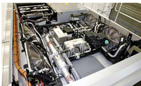
(c) Le système de refroidissement
