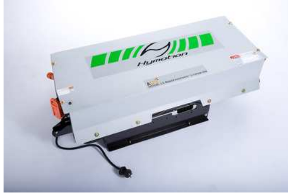
(b) bloc de batterie
