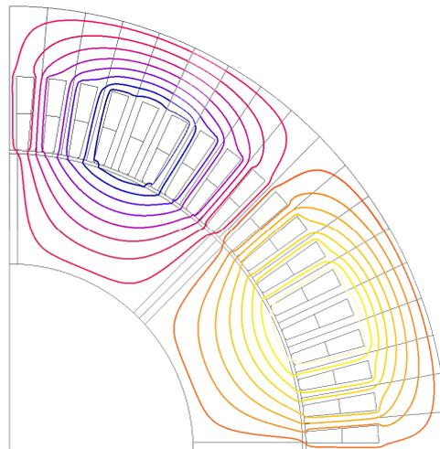
Figure 97 - Lignes de champ magnétique dues à la réaction magnétique d'induit d'axe  $q$
