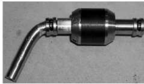
Figure 9 - Rotor endommagé (arbre déformé) par une résonance mécanique [Ede02]
