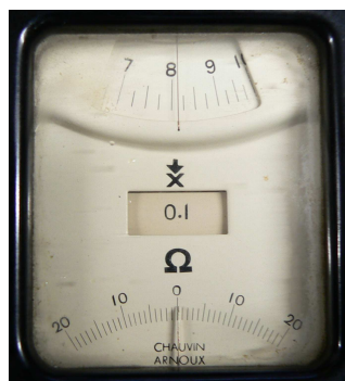
Figure 151 - Mesure de la résistance d'induit avec un ohmmètre de précision
