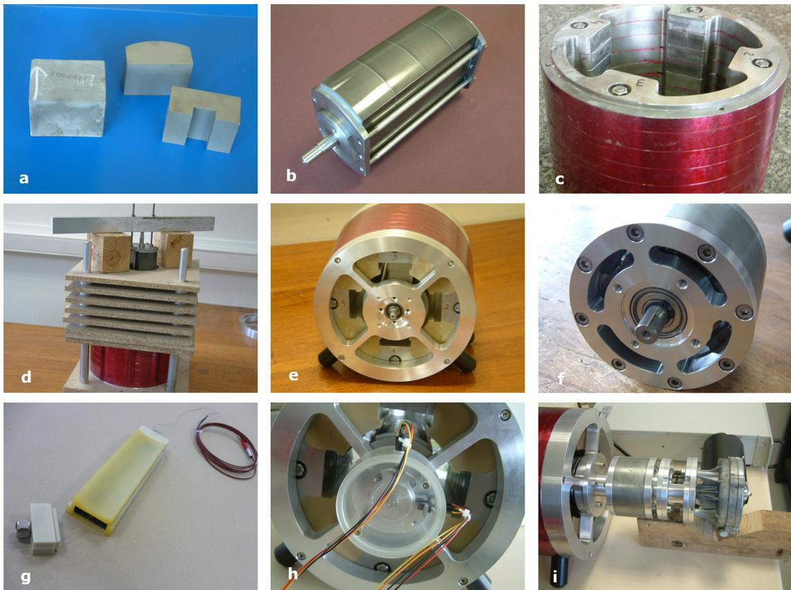
FIGURE III.14 – Principaux éléments constituant le prototype : a) blocs d'aimants brut et usinés, b) rotor complet, c) culasse en acier, d) montage du rotor dans la culasse, e) culasse et rotor assemblés, f) compensateur de couple, g) fourreau contenant le matériau actif, h) capteurs de position du rotor, i) ensemble stator, rotor, compensateur et moteur.
