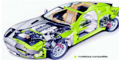
Figure 1-1 Exemple d'utilisation des matériaux composites (GD) : Aston Martin V12
