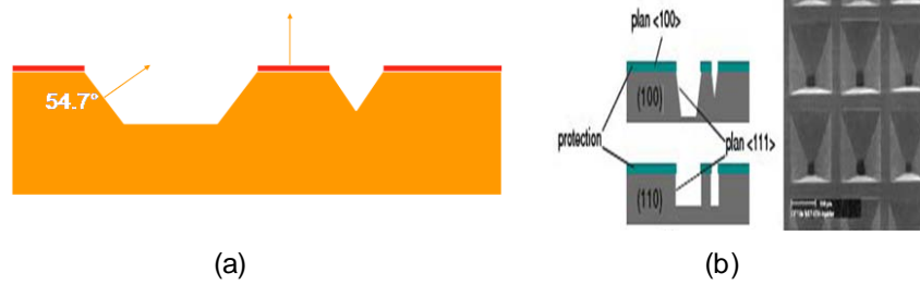
Figure II. 3 : Différents profils de gravure humide anisotrope en silicium cristallin pour application unique; (b) des exemples de micropuits faits par gravure humide anisotrope [72].
