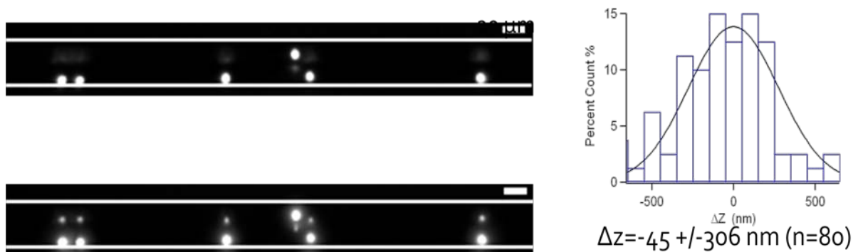
Figure II. 13: Panneau de gauche : billes fluorescentes (grande intensité) collées sur la surface d'une lamelle et leurs réflexions (intensité plus petite). L'erreur calculée entre les trois valeurs La distance en z entre ces billes, qui sont physiquement collées sur une lamelle, est mesurée à partir des réflexions, confirmant qu'elles sont toutes dans un même plan à 300 nm près.
