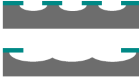
Figure II. 2: Phénomène de sous-gravure lors de la gravure humide isotrope.
