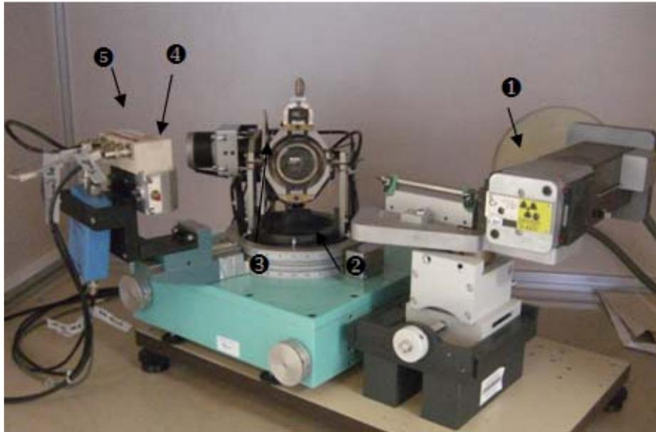
Figure 2-25 Diffractomètre utilisé pour la détermination de contraintes résiduelles du I<sup>er</sup> ordre
