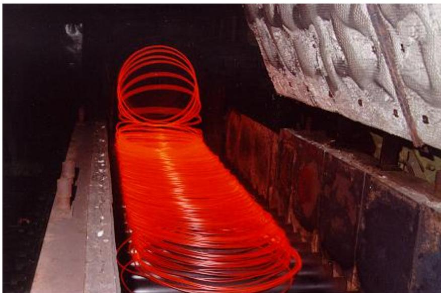
Figure 1-13 Vue générale de la ligne de refroidissement contrôlé à l'air (procédé Stelmor)
