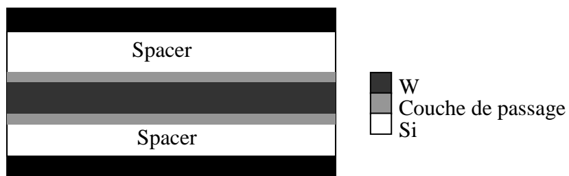
Figure III.10 : Schéma du guide d'onde utilisé pour les simulations : modèle à 5 couches avec la couche de tungstène, deux couches de passage, le spacer de silicium et les deux couches réfléchissantes pour confiner le champ.
